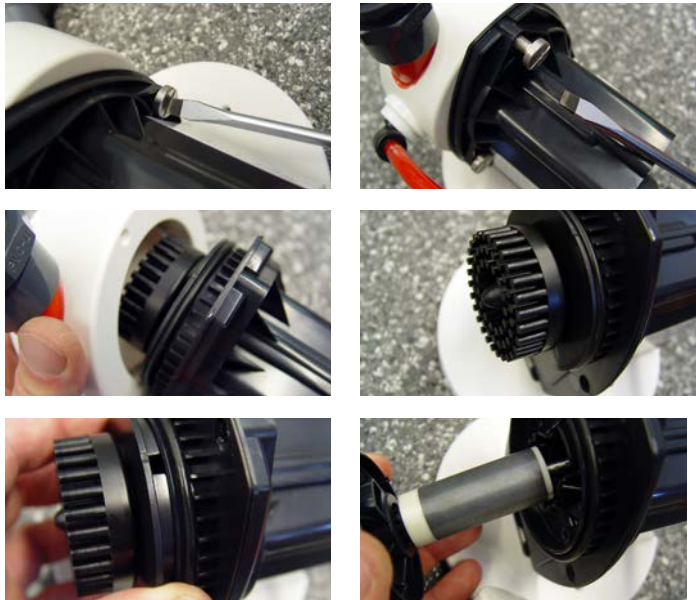
O-Ring in korrekter Position
