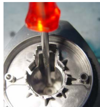
O-Ring in falscher Position
