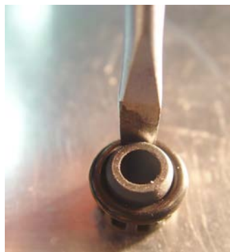
O-Ring in korrekter Position
