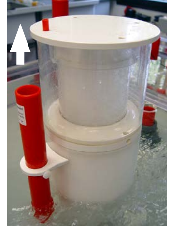
Düsenteil mit Luft- und Ozon- Anschluss
